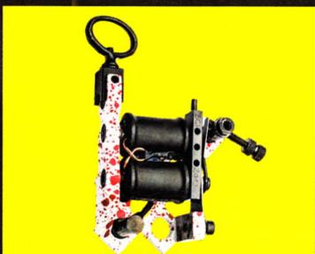
Die Spulen sind das »Herz« der BCI-Maschinen; sie werden einzeln von Hand gewickelt!
